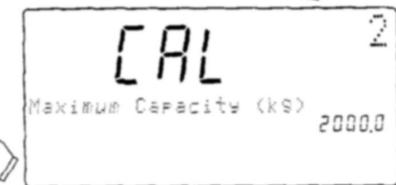
5. Presione la tecla **ENTER** nuevamente para arreglar la CAPACIDAD introducida y la báscula remota estará lista para la calibración.
