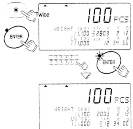
4. Utilice el teclado numérico de 10 dígitos para configurar la hora y presione la tecla **ENTER** para regresar al modo normal. El reloj comenzará de "00" segundos.
