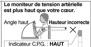
La position de l'appareil est contrôlée avant et après la mesure. Si les deux contrôles indiquent que la position de prise de mesure est correcte, l'indicateur CORRECT s'allume en bleu. Pour toutes les autres mesures, un indicateur de position BAS ou HAUT s'allume en orange.
