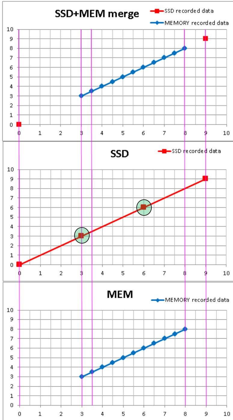
模擬資料的樣本。(將轉換範圍設定為 0~10 且 SSD+MEMORY 資料合併的情況下) 上面的波浪形為轉換檔案後的合併資料，中間為 SSD 記錄資料，下面為 MEMORY 記錄資料。SSD 記錄 (Normal) 的情況下，剔除的資料和 MEMORY 記錄的資料同值。
