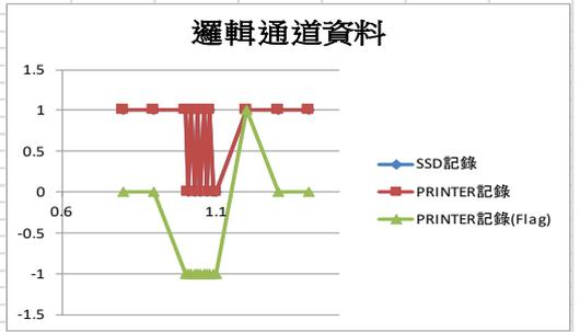
合併 Normal 和 P-P (Level、Flag) 的示意圖。P-P 的情況下，將 MEMORY 記錄的值複製於 Level，Flag 為-1 (不固定的意思)。
