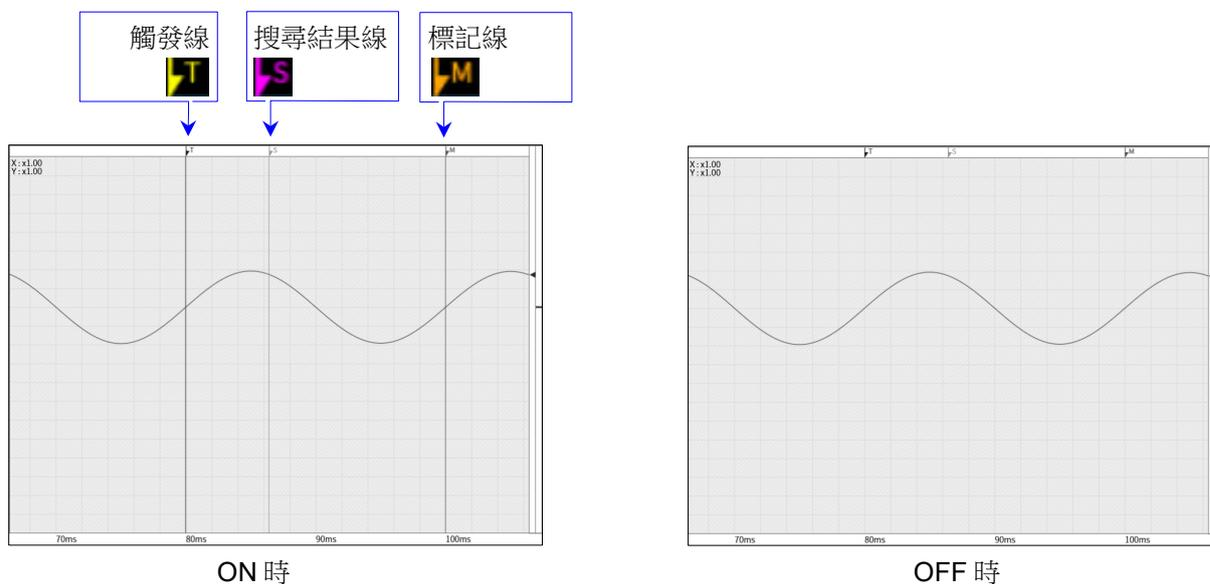
追蹤游標： ON 的情況下，游標移動至波形監視器外時，顯示波形和游標。OFF 的情況下，移動至波形監視器外時，波形不會移動，僅游標移動。(不會顯示游標線。)
