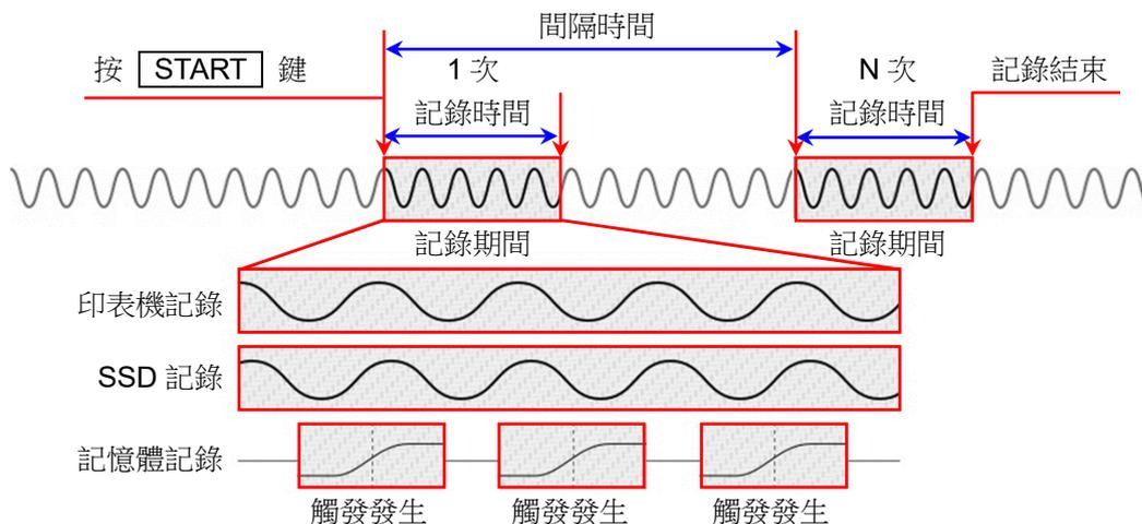
按操作面板的 **START** 鍵，就會開始記錄至各裝置，進行在記錄設定的【記錄時間】設定的時間記錄後，1 次記錄結束，從測量開始起經過【間隔時間】，開始下一次記錄。進行間隔的【記錄次數】中設定的次數的記錄後，測量結束。
