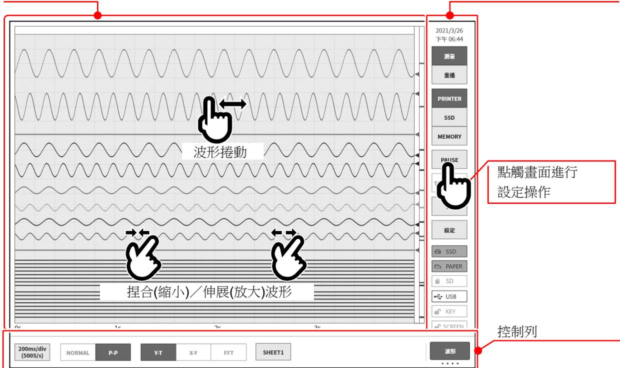
**波形監視器：** 可在波形監視器上觀測輸入訊號的狀態，重播記錄資料。透過捏和／伸展進行波形的縮小／放大、波形捲動。
