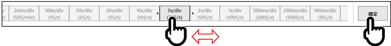
點觸取樣速度後，將會顯示在此速度下取樣的波形。
