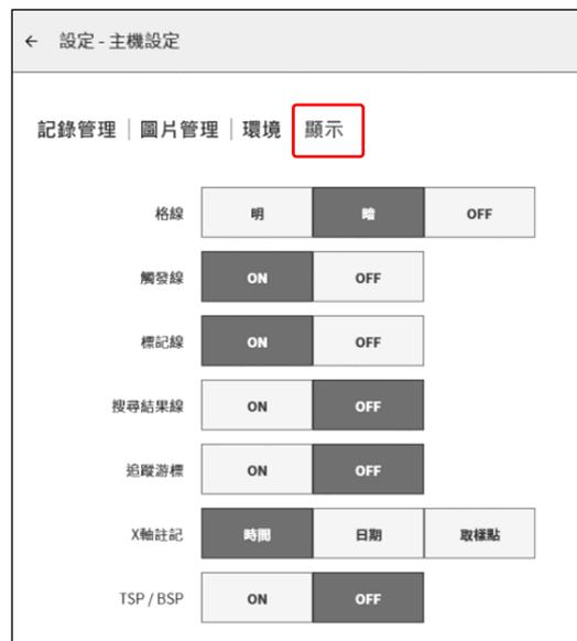
波形監視器的觸發線、標記線、搜尋結果線顯示
