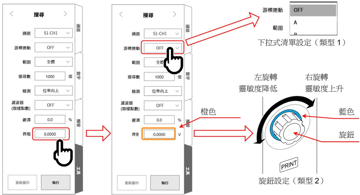
步驟 5. 設定完成後，點觸【執行】鍵。開始搜尋，結束後，其結果的周邊波形和 S 標記顯示於 Y-T 波形上，側邊選單切換成「7.5.10. 搜尋顯示選單」。依照搜尋結果的顯示位置，S 標記的顯示位置會改變。此外，中斷搜尋的情況下，會顯示搜尋到一半的結果，S 標記顯示於中央。
