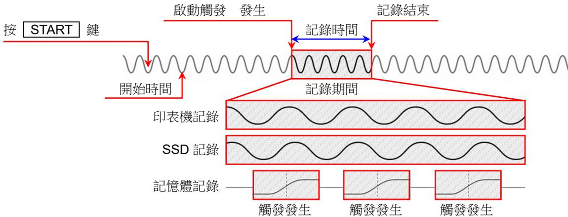
按操作面板的 **START** 鍵，就會變成測量準備狀態，等到以【開始時間】設定的時間後，檢測到以【啟動觸發】指定的通道的觸發，就會開始記錄至各裝置，記錄至以記錄設定的【記錄時間】設定的時間，或者按操作面板的 **STOP** 鍵為止。
