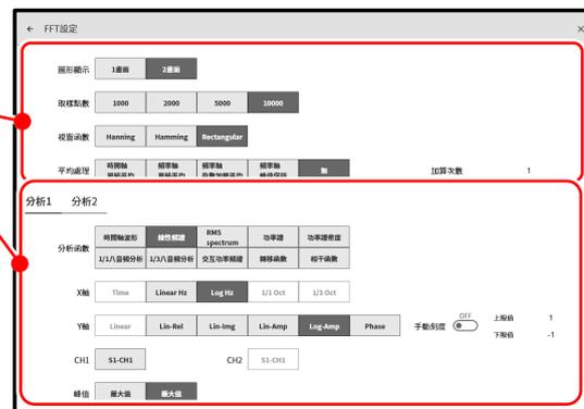
通道設定： 設定分析對象的通道。根據分析類別【時間軸波形】～【1/3八音頻分析】變為僅 1 訊號分析 CH1 的設定，【交互功率頻譜】～【相干函數】需要 2 訊號分析 CH1、CH2 的設定。
