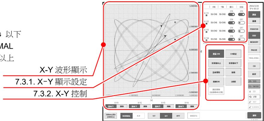
若點觸顯示控制的【1 畫面/4 畫面】鍵，便會如圖所示在 1 畫面中顯示 4 個波形，切換至 4 畫面分隔顯示。
