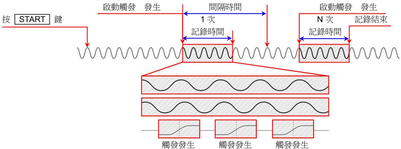
按操作面板的 **START** 鍵，就會變成測量準備狀態，檢測到在【啟動觸發】指定的通道的觸發，就會開始記錄。進行記錄設定的【記錄時間】中設定的時間的記錄後，1次記錄結束，從記錄開始經過【間隔時間】後開始下一次測量，等待下一次啟動觸發。
