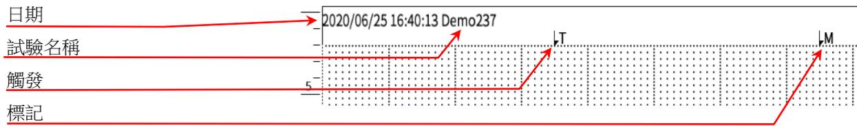
時間軸： 請選擇【ON】、【OFF】。標記為「8.2.6 顯示」的 X 軸標記設定。X 軸標記設定為「日期」的情況下，以 2 行列印。
