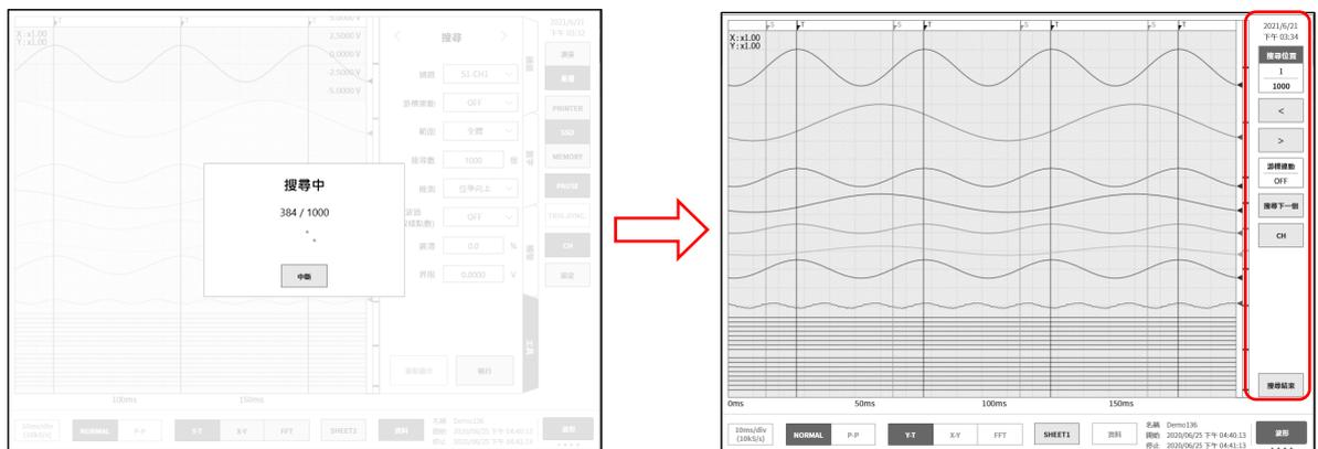
步驟 6. 搜尋結果 1 筆以上的情況下，在「7.5.10. 搜尋顯示選單」按【<】鍵(往前移動 1 筆)、【>】鍵(往後移動 1 筆)，波形顯示就會更新。能夠按【CH】鍵，回到 CH 設定子選單，重新設定搜尋條件。按【搜尋結束】鍵，從「7.5.10. 搜尋顯示選單」，回到基本的側邊選單。
