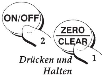
**Schritt 1** Schalten Sie die Anzeige AUS, halten Sie dann die ZERO/CLEAR-Taste gedrückt und drücken Sie gleichzeitig die ON/OFF-Taste.
