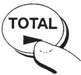
**Schritt 6** Drücken Sie die TOTAL-Taste, um die akkumulierte Stückzählung anzuzeigen.
