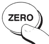
**Schritt 1** Die *Gewichts*anzeige sollte auf Null stehen und der NULL-Indikator soll leuchten. Falls die *Gewichts*anzeige *nicht* auf Null steht, drücken Sie die ZERO-Taste (in diesem Beispiel verwenden wir eine HD-12KB).
