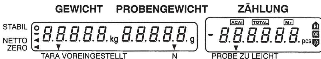
Die HD-B Zählwaage hat drei Anzeigen: die Gewichtsanzeige, die Probengewichtsanzeige und die Zählanzeige.
