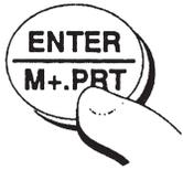
**Schritt 3** Drücken Sie zum Speichern des Probengewichtswertes die ENTER/M+/PRT-Taste.
