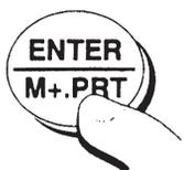
**Schritt 4** Drücken Sie die ENTER/M+/PRT-Taste, um das Behältergewicht (TARA) im Speicher abzulegen.
