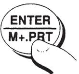
**Schritt 8** Vergewissern Sie sich, daß die Wägeplatte unbelastet ist und drücken Sie die ENTER/M+/PRT-Taste, um die Nullpunkt-Kalibrierung durchzuführen.
