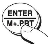
**Schritt 10** Drücken Sie die ENTER/M+/PRT-Taste, um die Kalibrierung bei voller Last (Endwert) durchzuführen.
