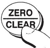
**Schritt 2** Leuchtet der ZERO-Indikator *nicht* auf, dann drücken Sie die ZERO/CLEAR-Taste.
