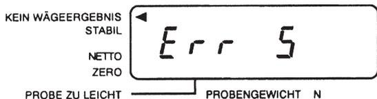
Die Waage kann nicht rechtzeitig stabil werden, damit der Befehl ausgeführt werden kann.
