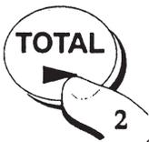
**Schritt 2** Halten Sie die ZERO/CLEAR-Taste gedrückt und drücken Sie dann gleichzeitig die TOTAL-Taste.
