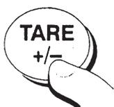
**Schritt 2** Drücken Sie die TARE-Taste. Der NETTO-Indikator erlischt und das Behältergewicht wird gelöscht.
