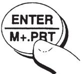
**Schritt 3** Wenn Sie die geeignete Gravitätsbeschleunigung eingegeben haben, dann drücken Sie die ENTER/M+/PRT-Taste, um Ihre Gravitätseinstellung im Speicher abzulegen.
