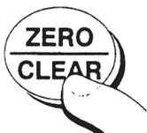
**Schritt 1** Die Anzeige sollte auf Null stehen und der Null-Indikator soll aufleuchten. Ist der Null-Indikator *nicht* an, dann drücken Sie die ZERO/CLEAR-Taste.
