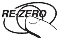
**Schritt 6** Versichern Sie sich, daß die Wägeplatte unbelastet ist und drücken Sie dann die RE-ZERO-Taste, um die Nullpunkt-Kalibrierung durchzuführen.
