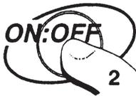
**Schritt 1** Schalten Sie die Anzeige aus, halten Sie dann die **RANGE**-Taste gedrückt und drücken Sie gleichzeitig die **ON:OFF**-Taste.
