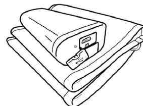
2. Conecte el cable de carga.
