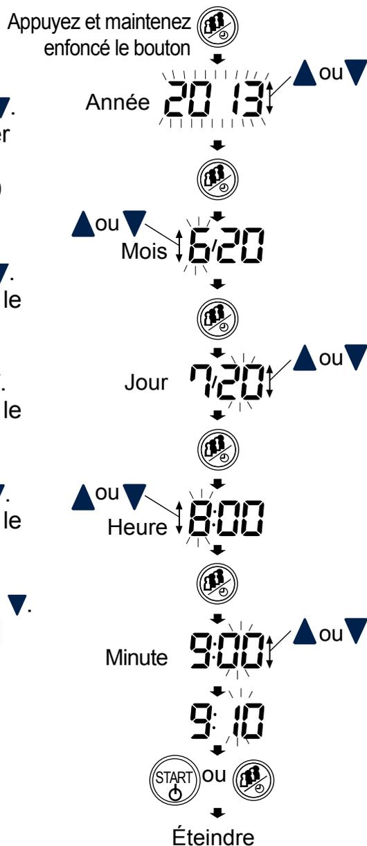
Appuyer sur le bouton **START** permet d'éteindre l'appareil à tout moment.
