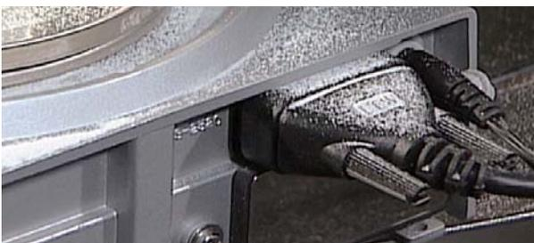
*Wasserdichtes RS-232C Datenkabel (optional)*
